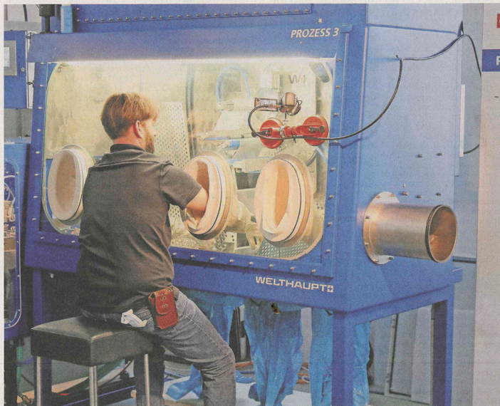
In dieser Anlage werden die Akkus in ihre Bestandteile zerlegt. Foto: Paoo Carrasosso
