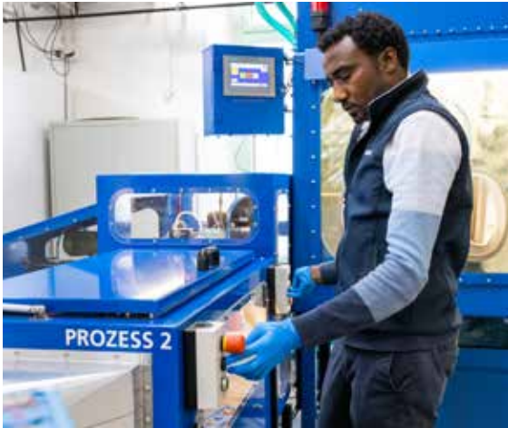
Ein Kyburz-Mitarbeiter überwacht die Öffnung der Zellen und die Entnahme ihrer Hauptbestandteile
